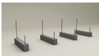
A Baterea stâlpilor în sol
