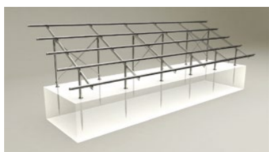
D Montajul panelor și contravântuirilor
